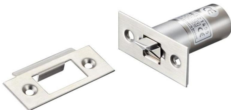
Миниатюрные электромеханические соленоидные замки серии ST-DB080 предназначены для работы в составе систем контроля доступа с электронным управлением блокировкой дверей. ST-DB080NO – это нормально-открытый замок, т.е. он разблокируется при отключении питания и блокируется при его наличии, а ST-DB080NC – нормально-закрытый, т.е. он разблокируется при подаче питания и блокируется при его отключении.
