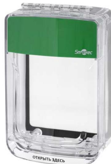
Защитный кожух с откидной крышкой ST-ER100SM предназначен для дополнительной защиты ручных извещателей и устройств разблокировки от воздействия окружающей среды, а также для предотвращения случайной активации или вандализма. В корпус кожуха может быть установлен звуковой оповещатель, который включается при открытии крышки защитного кожуха ST-ER100SM. Поддерживается установка ручных извещателей и устройств разблокировки, как накладным, так и врезным способом.
