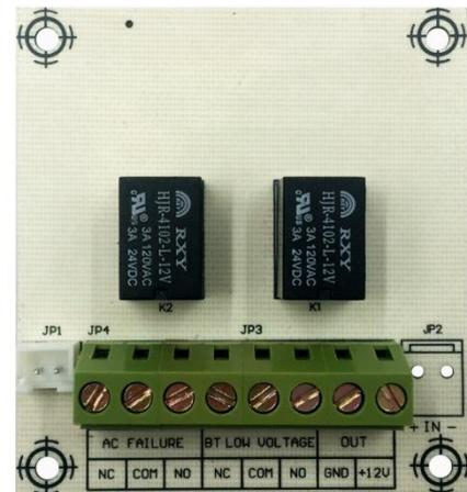
Модуль с реле мониторинга ST-PS200RB предназначен для расширения базового функционала источников питания ST-PS205E-BK. Устройство позволяет выполнять мониторинг линии 220 В и аккумуляторной батареи.
