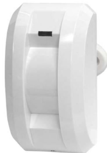
Инфракрасный пассивный извещатель с линзой типа «штора» ST-AD015P предназначен для обнаружения движения и защиты объекта от несанкционированного проникновения. Комбинированное использование сдвоенного пироэлемента, цифровой обработки сигнала и термокомпенсации позволяет минимизировать количество ложных срабатываний. Извещатель имеет высокую устойчивость к электромагнитным и радиочастотным помехам, а в комплекте с ним поставляется настенный кронштейн.
