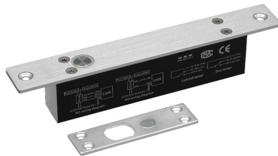
Электромеханический соленоидный замок ST-DB210MDT предназначен для работы в составе систем контроля доступа с электронным управлением блокировкой дверей. Замок ST-DB210MDT является нормально-открытым, т.е. разблокируются при отключении питания и блокируются при его наличии. Для мониторинга положения створки двери в системе контроля доступа можно использовать соответствующий выход замка. Дополнительно модель ST-DB210MDT имеет релейный выход мониторинга положения ригеля.
