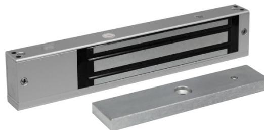
Электромагнитный замок ST-EL260L-SL предназначен для запираения дверей, контролируемых СКУД, а также дверей эвакуационных выходов. Одноцветная световая индикация обеспечивает визуализацию различных состояний замка: СИД не горит – нет питания, красный сигнал – на замок подано питание. Для преодоления остаточной намагниченности используется специальное цинковое покрытие якоря замка совместно с пружинным механизмом.
