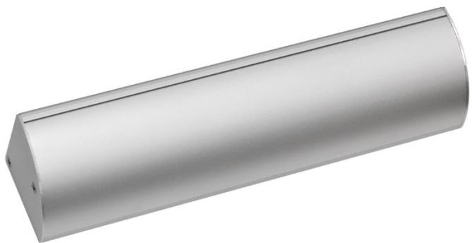
Кронштейн LC типа выполнен из алюминия и предназначен для крепления электромагнитных замков на открывающиеся наружу двери, когда глубина дверной коробки не допускает непосредственный монтаж замка. Кронштейн имеет возможность регулировки выноса замка от двери. Крышка кронштейна позволяет скрыть монтажные элементы замка и проводку, что придает более эстетичный вид входной группе и защищает проводку от преднамеренного повреждения.
