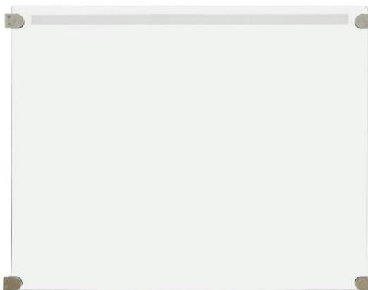
Стеклянная панель ограждения является элементом системы ограждений, предназначеннной для ограничения и направления потоков людей на объектах, оборудованных контролем доступа. Панель имеет в комплекте 4 кронштейна для монтажа к стойкам ограждения ST-GR110P-SS, ST-GR120P-SS, ST-GR121P-SS или ST-GR130P-SS. Панель выполнена из закаленного стекла толщиной 8 мм, длиной 1200 мм и высотой 859 мм.
