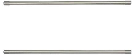
Поручни из нержавеющей стали являются элементом системы ограждений, предназначенной для ограничения и направления потоков людей на объектах, оборудованных СКУД. Два поручня имеют в комплекте соединительные стаканы, предназначенные для крепления к стойкам ограждения ST-GR010P-SS, ST-GR020P-SS, ST-GR021P-SS или ST-GR030P-SS. Поручни выполнены из трубы длиной 1,5 м и диаметром 30 мм.
