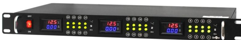
Профессиональный блок питания ST-PS110RM-BK предназначен для высококачественного электропитания напряжением 12 В постоянного тока оборудования видеонаблюдения и других устройств без необходимости резервирования питания. Индивидуальная защита для каждого выходного канала с помощью самовосстанавливающихся предохранителей обеспечивает независимость питания подключаемых устройств.
