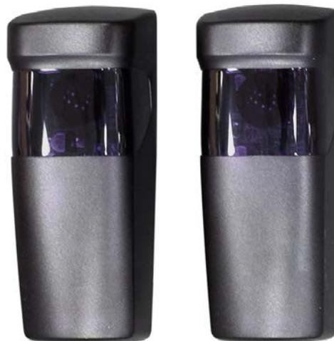
Фотоэлемент ST-RB001PD предназначен для обнаружения пересечения инфракрасного луча автотранспортом или человеком. Он применяется в качестве устройства безопасности в составе системы контроля автомобильного проезда под управлением шлагбаума или как инициирующее устройство автоматизации проезда. Регулировка приемника и передатчика по горизонтали  $\pm 90^\circ$  позволяет устанавливать их на непараллельные друг другу поверхности или со сдвигом.
