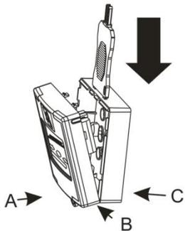
Зафиксируйте монтажное основание **С**, протяните и подключите кабель.
