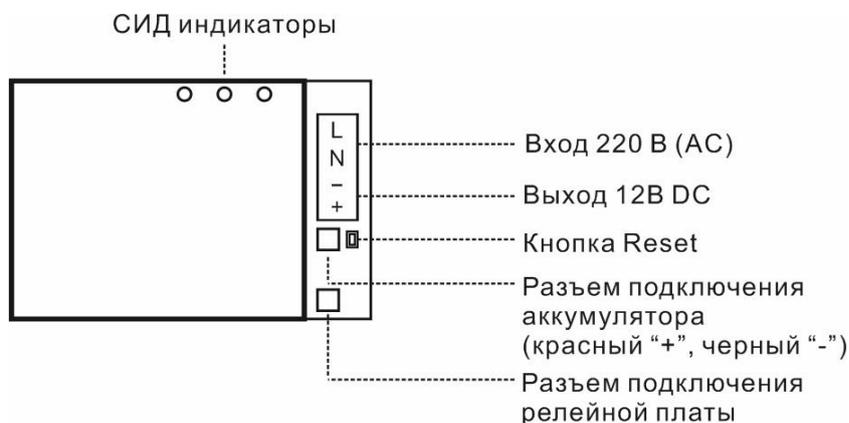
1. Закрепите блока питания с использованием винтов или на DIN-рейке стандарта TS35/7,5 или 15.
